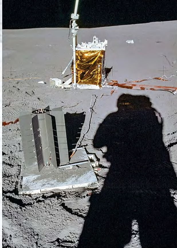
■ L'ALSEP. Au premier plan, le RTG ( Radioisotope Thermoelectric Generator ). À l'arrière-plan, la Station Centrale de la station scientifique ALSEP ( Apollo Lunar Scientific Experiment Package ). L'ombre est celle de Shepard. NASA
