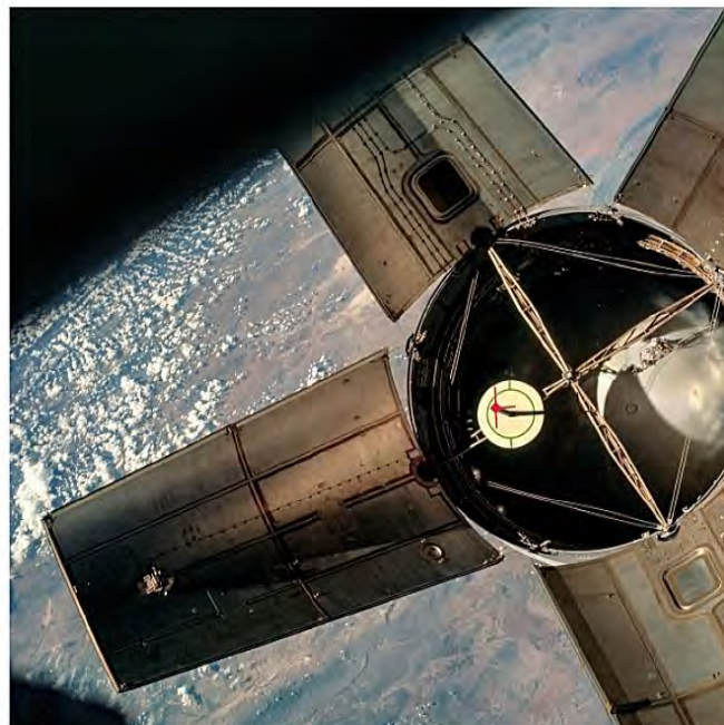
■ L'étage S-IVB de la Saturne IB avec son adaptateur contenant une cible pour simuler un amarrage avec le LM. NASA
